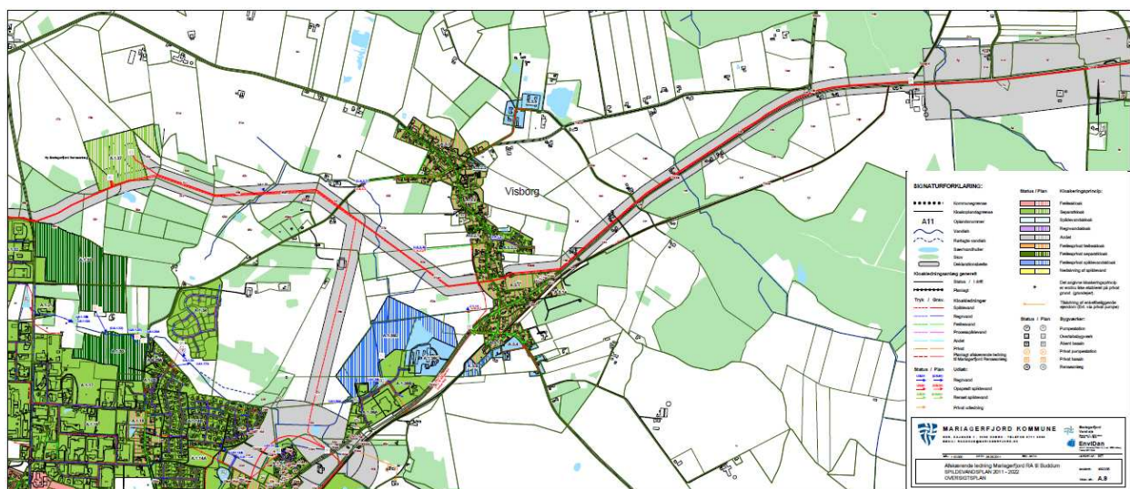
Figur 4 Trace for afløbsledning fra renseanlæg til recipienten Kattegat.
